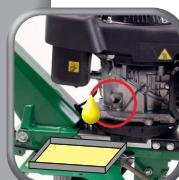
Schraube lösen, Bodenhacke
