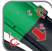
Fangsack und Saugrohr entfernen
