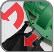
Fangsack am Klettverschluss entfernen
