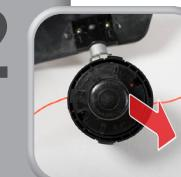
Fadenspule entfernen, entsorgen
