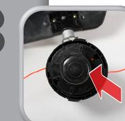
Neue Spule einsetzen
