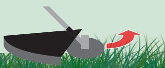
Aufgrund Messerdrehrichtung von rechts nach links arbeiten
