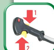
Gashebel-Entriegelung und Gashebel gleichzeitig drücken
