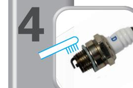
Rückstände mit Drahtbürste reinigen
