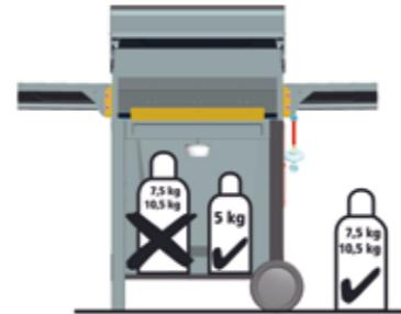
**ACHTUNG:** Es dürfen während dem Betrieb des Grills nur Gasflaschen mit max. 5 kg Füllgewicht auf den Grillboden gestellt werden. Größere Gasflaschen sind während der Nutzung und bis zum auskühlen der Grillwanne neben dem Grill zu platzieren. Den Anschluss bzw. Wechsel der Flasche immer an einem gut belüfteten Ort fern von offenen Flammen, Funken oder Wärmequellen vornehmen. Beachten und befolgen Sie die Sicherheitsvorschriften, die auf den verwendeten Gasflaschen vermerkt sind.
