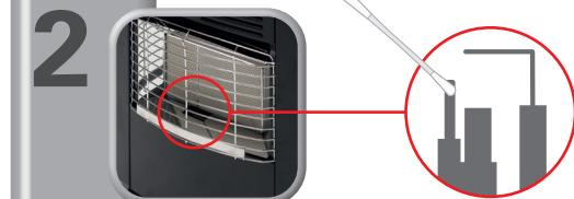
Bei Verschmutzung: Thermosicherung vorsichtig reinigen
