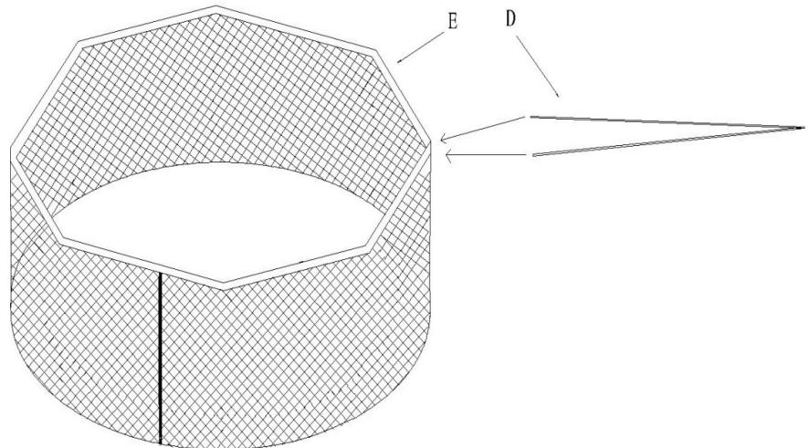
Fiberglasstange (D) oben in die Führung (E) am Fangnetz schieben.
