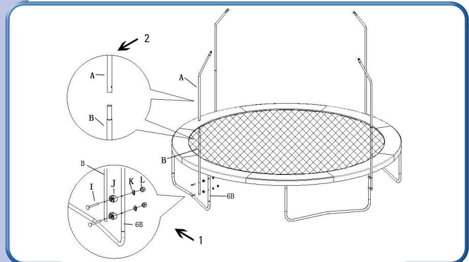
Untere Netzstütze an den Füßen befestigen (1), obere Netzstützen aufschieben (2).
