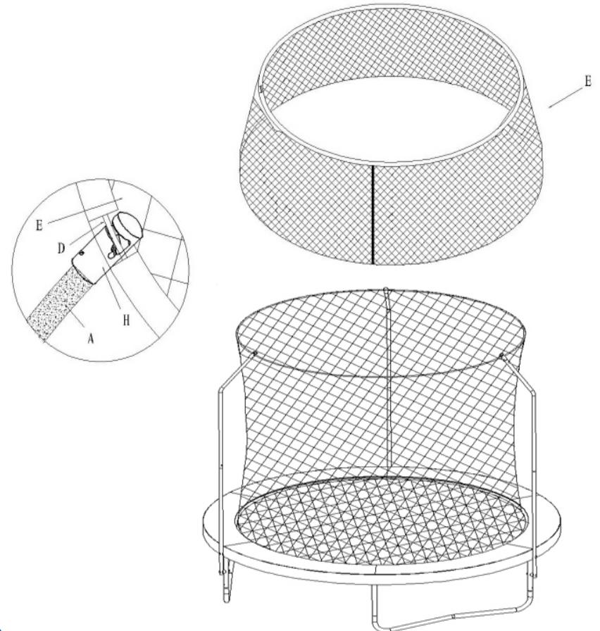
Fiberglasstange (D) am Fangnetz (E) oben in den Plastikverbindern (H) einhängen.
