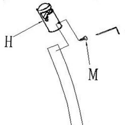
Plastikverbinder (H) auf obere Netzstütze (A) aufsetzen und mit Fixierschraube (M) fixieren.
