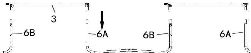
Vier Fuss-Bögen mit den Toprohren mit Sockel zu einem Kreis verbinden.
