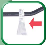
Halterung für Pistole montieren
