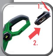
Verstauen: Akku vom Gerät entfernen
