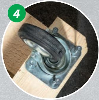
*Fixez les roulettes mobiles à l'aide des vis et des rondelles de carrosserie (respectivement 4 par roulette).*
