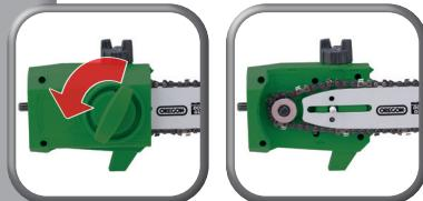
Mutter lösen und Abdeckung entfernen
