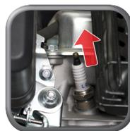
Motorbremshebel loslassen, Zündkerze entfernen → S. 18
