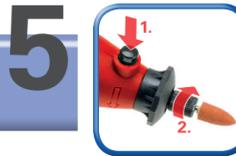
**5** Spindelarrretierung gedrückt halten, Spannmutter festschrauben
