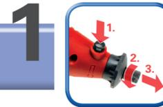
**1** Spindelarrretierung drücken und Spannmutter abschrauben
