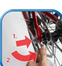
Schnellspanner am Hinterrad lösen und durch mitgelieferten ersetzen, anziehen
