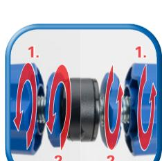
Hinterrad am Trainer befestigen, Schrauben beidseitig anziehen
