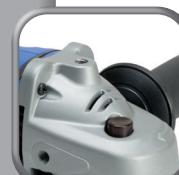
Lüftungsschlitz mit Pinsel reinigen
