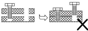
Ziehen Sie Schrauben und Muttern erst dann vollständig an, wenn alle Schrauben montiert sind.
