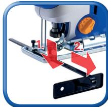
Anschlag und Sägeblatt entfernen
