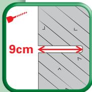
Löcher mit 14mm Steinbohrer vorbohren.
