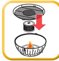
Ventilator auf MAX. einschalten, Brennpaste mit Stabfeuerzeug entzünden
