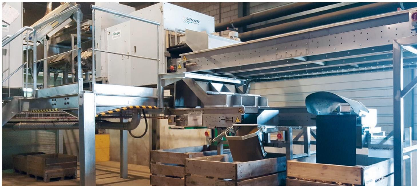
La nouvelle installation permet de trier et de calibrer jusqu'à 120 000 tubercules à l'heure.
