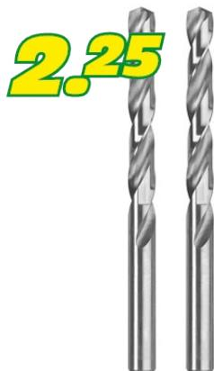
Für Stahl, Stahlguss, Temperguss, Sinterreisen, Nichteisenmetalle, Hartkunststoffe. Präzisionsgeschliffen, Spitzwinkel 135°, selbstzentrierend. Material: HSS. Norm: DIN 338, DIN 1412 C.
