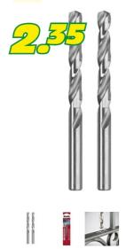
Für Legierten und unlegierten Stahl, Grauguss, NE-Metalle, Hartkunststoffe. Rechtsschneidend, Typ N, rollgewalzt, dampfangelassen, Spitzwinkel 118°. Material: HSS. Norm: DIN 338.
