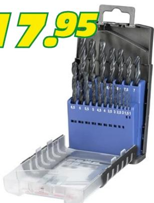
Für Stahl, Grauguss, NE-Metalle, Hartkunststoffe. Rechtsschneidend, Typ N, rollgewalzt, dampfangelassen, Spitzwinkel 118°. Material: HSS. Norm: DIN 338.
