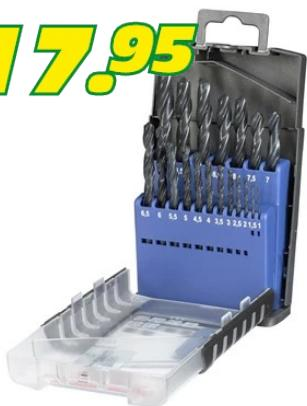
Für Stahl, Grauguss, NE-Metalle, Hartkunststoffe. Rechtsschneidend, Typ N, rollgewalzt, dampfangelassen, Spitzwinkel 118°. Material: HSS. Norm: DIN 338.
