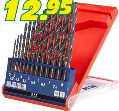
Bohrer für Stahl, Grauguss, NE-Metalle, Hartkunststoffe. Rechtsschneidend, Typ N, rollgewalzt, dampfangelassen, Spitzwinkel 118°. Material: HSS. Norm: DIN 338.
