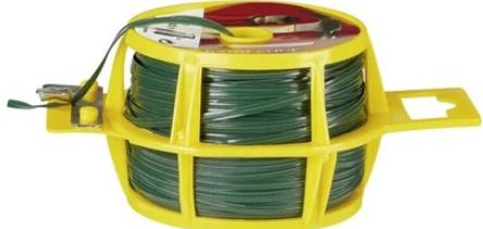
Drahtspulen für Haus und Garten. Aus verzinktem Innendraht (0,4 mm) und mit Kunststoffband (3 mm breit) überzogen. Spulen à 50 m mit Abschneider.
