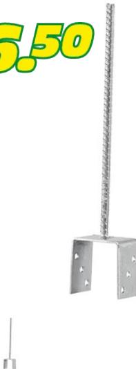
**Pfostenträger einteilig. Einbetonierbar, mit fixer U-Aufnahme und 400 mm langem Beton-Anker aus Riffelstahl. Masse: 91x400x60x4mm**
