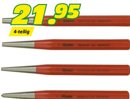
Aus Chrom-Molybdän-Vanadium-Lufthärtestahl. Schlagkopfgesichert. Bestehend aus 1 Körner 120x10mm, 1 Durchschlag 120x10x3mm, 1 Durchschlag 120x10x4mm und 1 Durchschlag 120x10x5mm.
