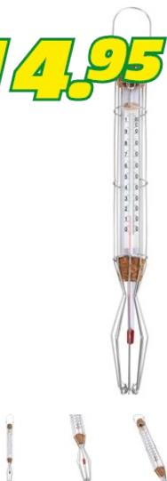
Prima Vista. Zur Überwachung der Temperatur von Flüssigkeiten, wie beispielsweise Milch, Säfte, Brühen oder Dünger in der Landwirtschaft. Bis zu 100 °C. Material: Metall, Glas.
