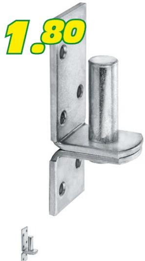
Für Überschlagtüren geeignet. Material: Stahl. Oberfläche: Verzinkt, blau passiviert. Abstand: 10 mm Durchmesser: Ø 10 mm. Plattengröße: 83 x 33 mm.
