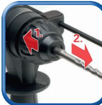
Schnellspannfutter zurückziehen, Bohrer entfernen
