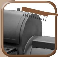
Rost mit Drahtbürste entfernen
