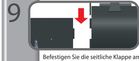
Befestigen Sie die seitliche Klappe am kleinen Zylinder wie abgebildet mit dem grossen Stift.
