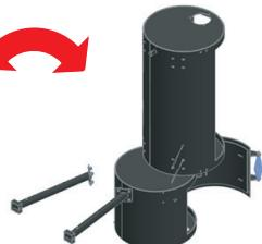
Führen Sie die beiden kurzen Beine in die Bodenlöcher des grossen Zylinders und befestigen Sie die Beine mit den Schrauben und Muttern aus BEUTEL A.
