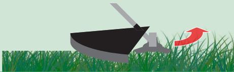
Aufgrund Messerdrehrichtung von rechts nach links arbeiten
