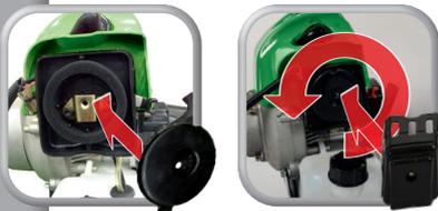
Filterabdeckung korrekt anbringen
