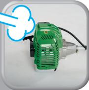
Gerät mit Druckluft (niedriger Druck) ausblasen
