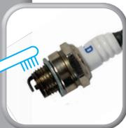
Rückstände mit Drahtbürste reinigen
