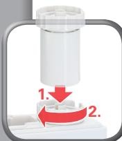
Deckel einsetzen, zuschrauben
