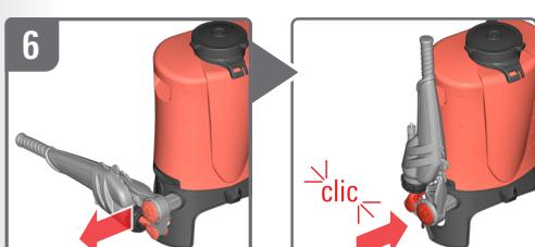
Pumpehebel herausziehen, vertikal einführen und ganz hineindrücken (Parkposition)
