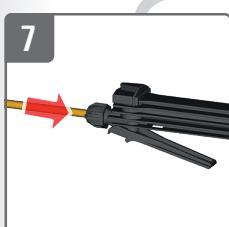
Sprührohr an Handventil stecken und festziehen
