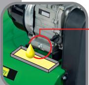
Schraube lösen, Oel vollständig
