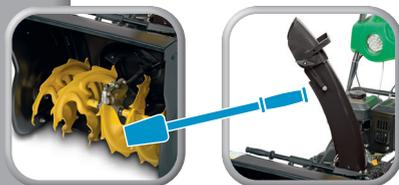
Mit dem Reinigungswerkzeug oder einer Schaufel Verstopfung entfernen.
