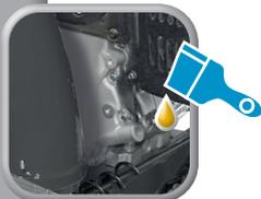
**Blanke Metallteile mit einer dünnen Schicht Öl bestreichen um Rost zu vermeiden**
