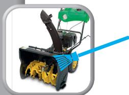
Schnee und Eis von der Schneefräse, dem Motor und allen Bedienelementen abbürsten.
