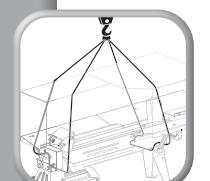
Spalter mit Riemen/Schleifen befestigen
