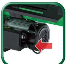
Stromkabel einstecken, Netzanschluss herstellen
