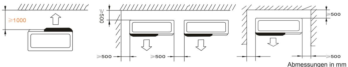
Platzieren Sie keine Gegenstände in weniger als 1 Meter Entfernung vor der Wärmepumpe.
