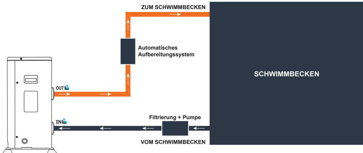
Der der Wärmepumpe vorgeschaltete Filter muss regelmäßig gereinigt werden, damit das zirkulierende Wasser sauber ist und etwaige Funktionsprobleme aufgrund einer Verschmutzung oder Verstopfung des Filters vermieden werden.
