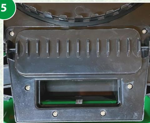
Abdeckung wieder montieren und anschrauben.
