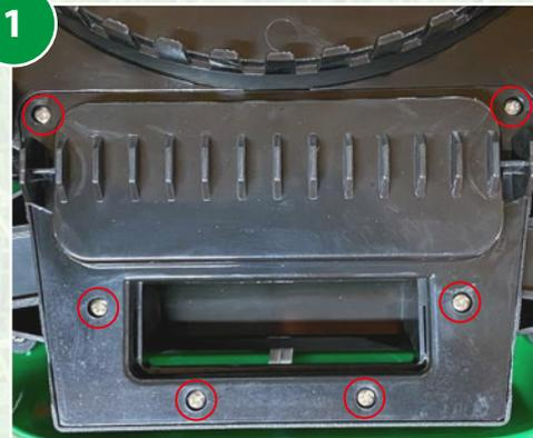
Die 6 Schrauben der Abdeckung lösen.
