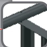
Befestigen Sie das Ablagegitter mit den Schrauben und Muttern aus BEUTEL C an den Beinen.
