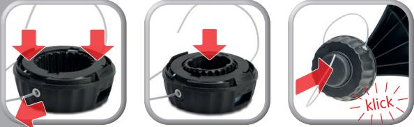
Neue Spule einsetzen, Fadenkopf aufdrücken
