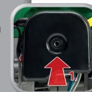
Filterabdeckung korrekt anbringen
