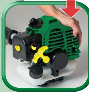
Gerät mit linker Hand gut fixieren
