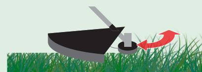
**Arbeitsrichtung:** Sichelartige Bewegungen, Fadenkopf parallel zum Boden, von rechts nach links arbeiten.
