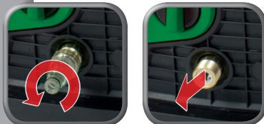
Adapter entfernen, Filter herausziehen
