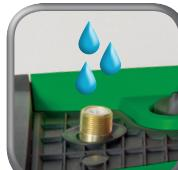
Gerät ablegen, Frostschutzmittel in Wasseranschluss füllen
