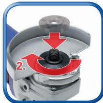
**Scheibe entfernen, Flansch aufsetzen**
