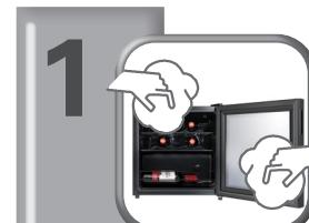
Innenraum und Dichtung mit heißem Spülwasser abreiben, nachtrocknen
