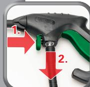
Hochdruckschlauch von Pistole entfernen
