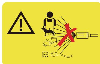
Mit dem Wasserstrahl nicht auf Menschen, Tiere, elektrische Geräte, Steckdosen oder das Gerät selbst zielen.
