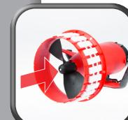
Propeller einsetzen, fest-schrauben
