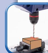
Mit der Bohrspitze das Werkstück touchieren, dann den Nullpunkt einstellen
