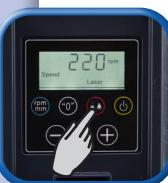
Bei Bedarf: Werkstück mit Hilfe von Laser ausrichten
