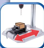
Bei Bedarf: Schraubstock ausrichten
