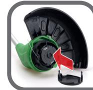
Neue Fadenspule in die dafür vorgesehenen Löcher einführen und einsetzen. Kunststoffabdeckung anbringen
