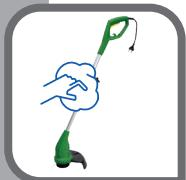
Bei Bedarf: Luftschlitz mit niedriger Druckluft ausblasen
