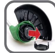
Kunststoffabdeckung entfernen und Fadenspule herausnehmen
