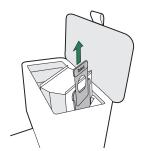
Hinweis: Dadurch wird der Beutel abgedichtet, sodass Staub und Schmutz nicht entweichen können.
