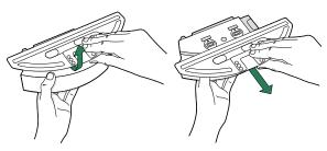
2 Entferne den Durchlaufaufsatz, indem du an der seitlichen Gummilasche ziehst.
