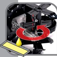
Schraube lösen, Oel vollständig
