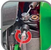
Schraube am Vergaser hineinschrauben
