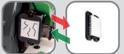
Neuen Filter und Gitter einsetzen
