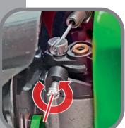
Schraube am Vergaser hineinschrauben
